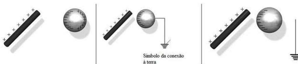
Figura 3 - Procedimento para eletrizar um condutor por indução (usando o aterramento)
